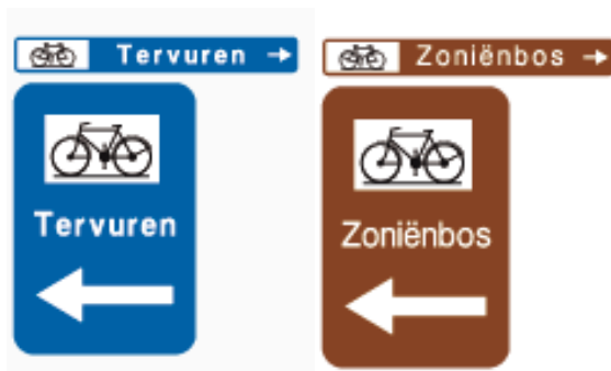
Figuur 56: Wegwijzer wegcode F34 aanbevolen reisweg voor fietsers. Links: functionele bestemming (F34b) - rechts: recreatief/toeristische (F34c)
